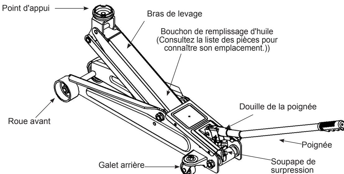
Figure 1 : Pièces d'un Cric rouleur à haut levage
