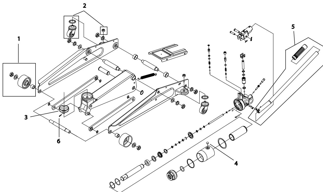
Figure 2 : Illustration des pièces de rechange du modèle F-2533
